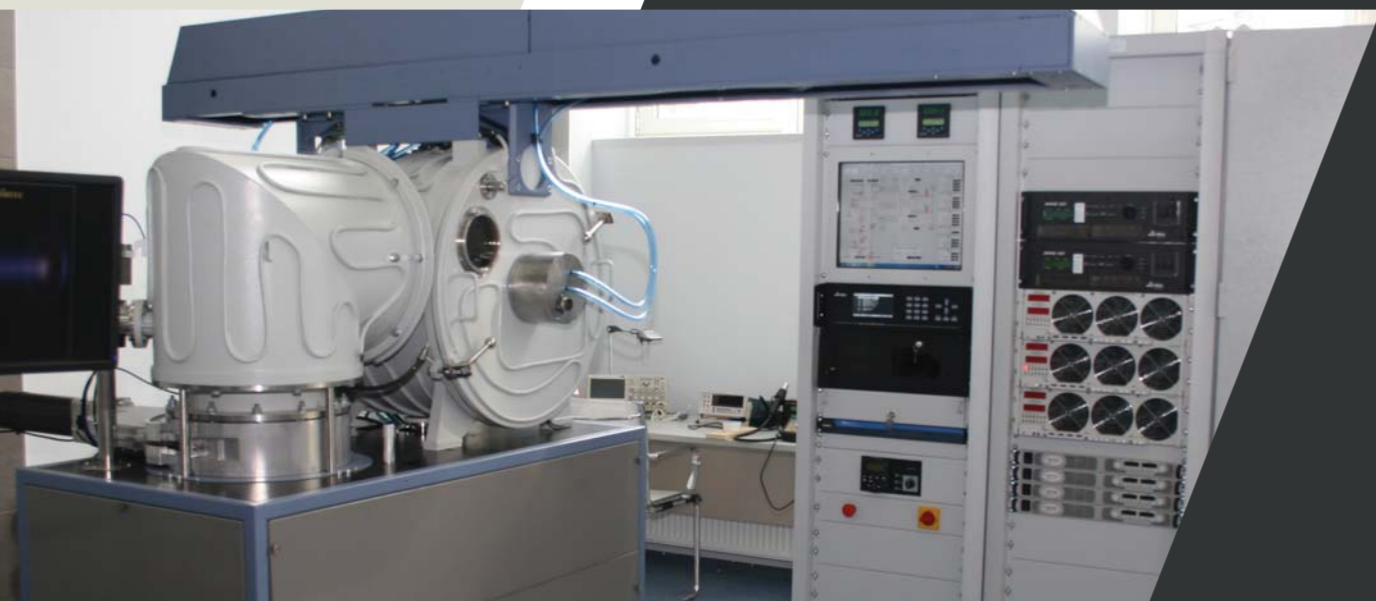
Экспериментальная установка для исследования параметров плазмы и изучения рабочих процессов в источниках и ускорителях низкотемпературной плазмы
