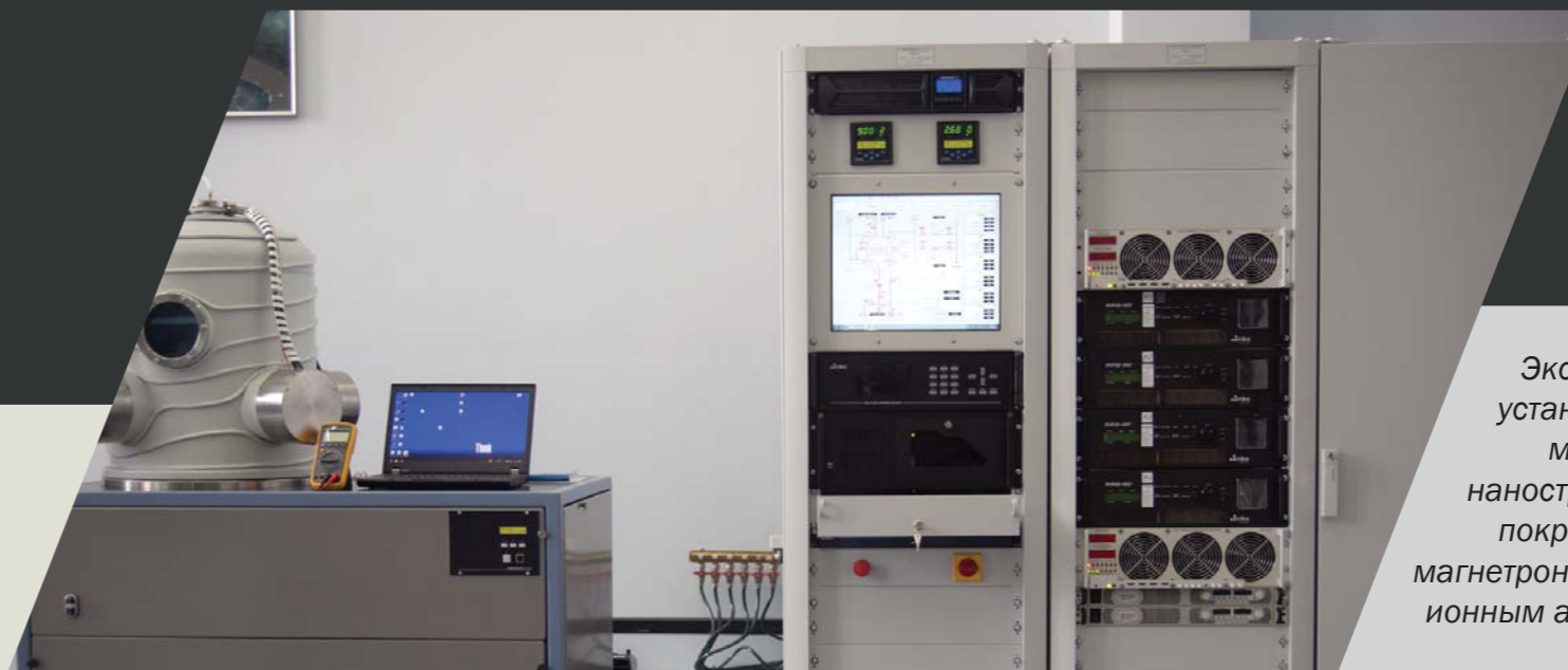
Экспериментальная установка для исследования процессов объемной ионной имплантации и процессов плазменно-стимулированной термодиффузии
