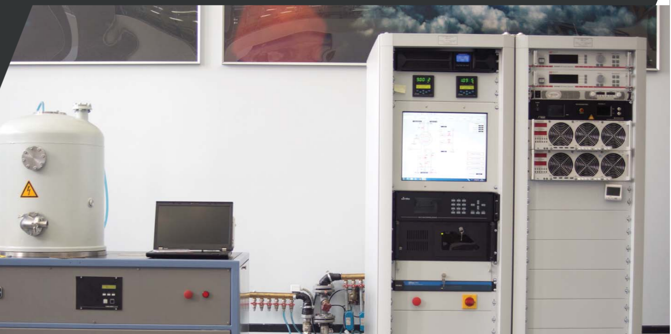
Экспериментальная установка для исследования процессов объемной ионной имплантации и процессов плазменно-стимулированной термодиффузии
