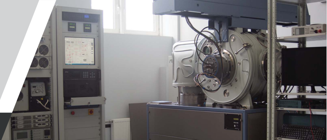
Экспериментальная установка для исследования физических процессов в вакуумно-дуговом разряде, синтеза калиброванных нано- и микро-порошков, нанесения упрочняющих и износостойких покрытий
